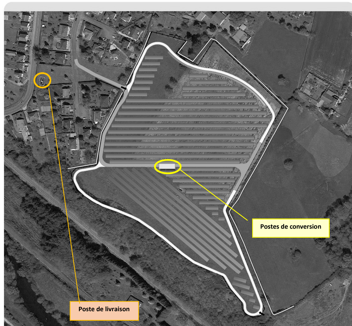
Localisation des postes électriques
